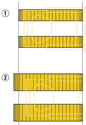
**Bodenplattentypen.** Der D6M kann mit unterschiedlichen Einsteg-Bodenplatten sowie Moorbodenplatten ausgerüstet werden, die aus gehärtetem Walzstahl bzw. Stahlguß gefertigt sind.
