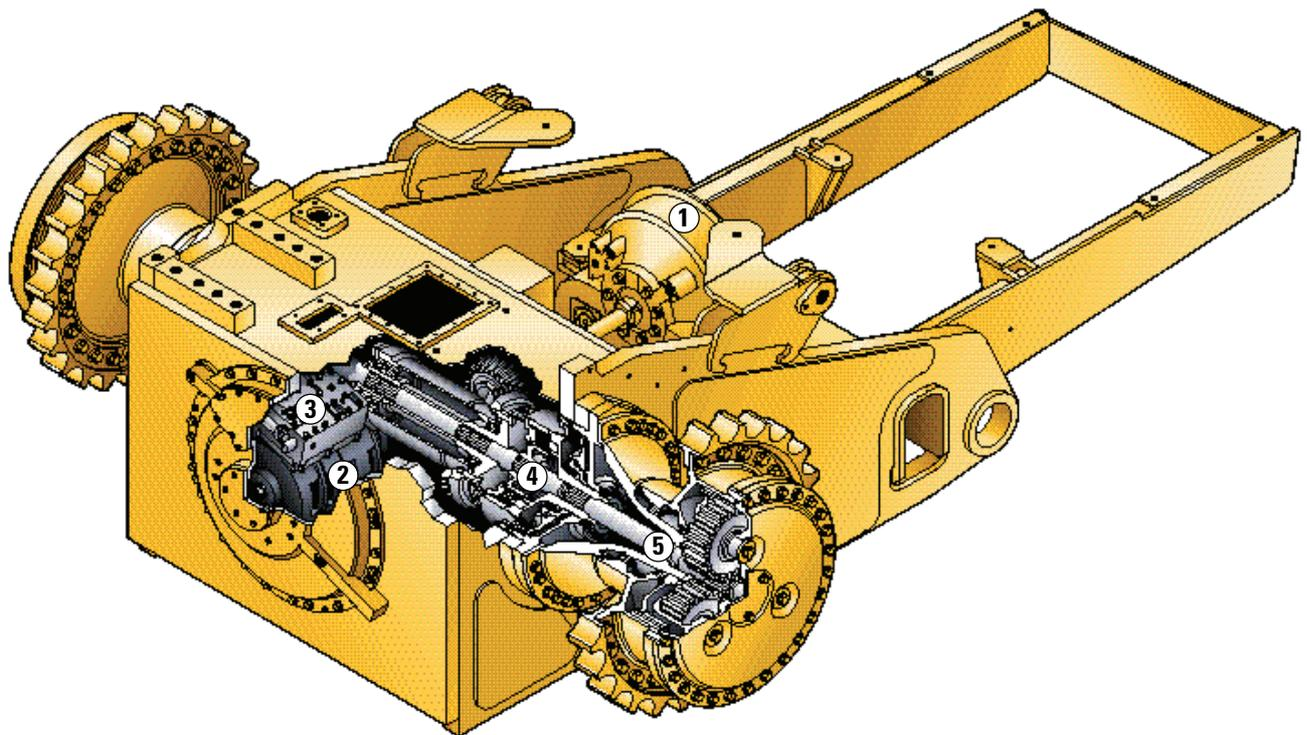
**Abstimmung.** Alle Komponenten der Kraftübertragung sind Caterpillar Produkte, so daß eine optimale Abstimmung durchgeführt werden konnte.
