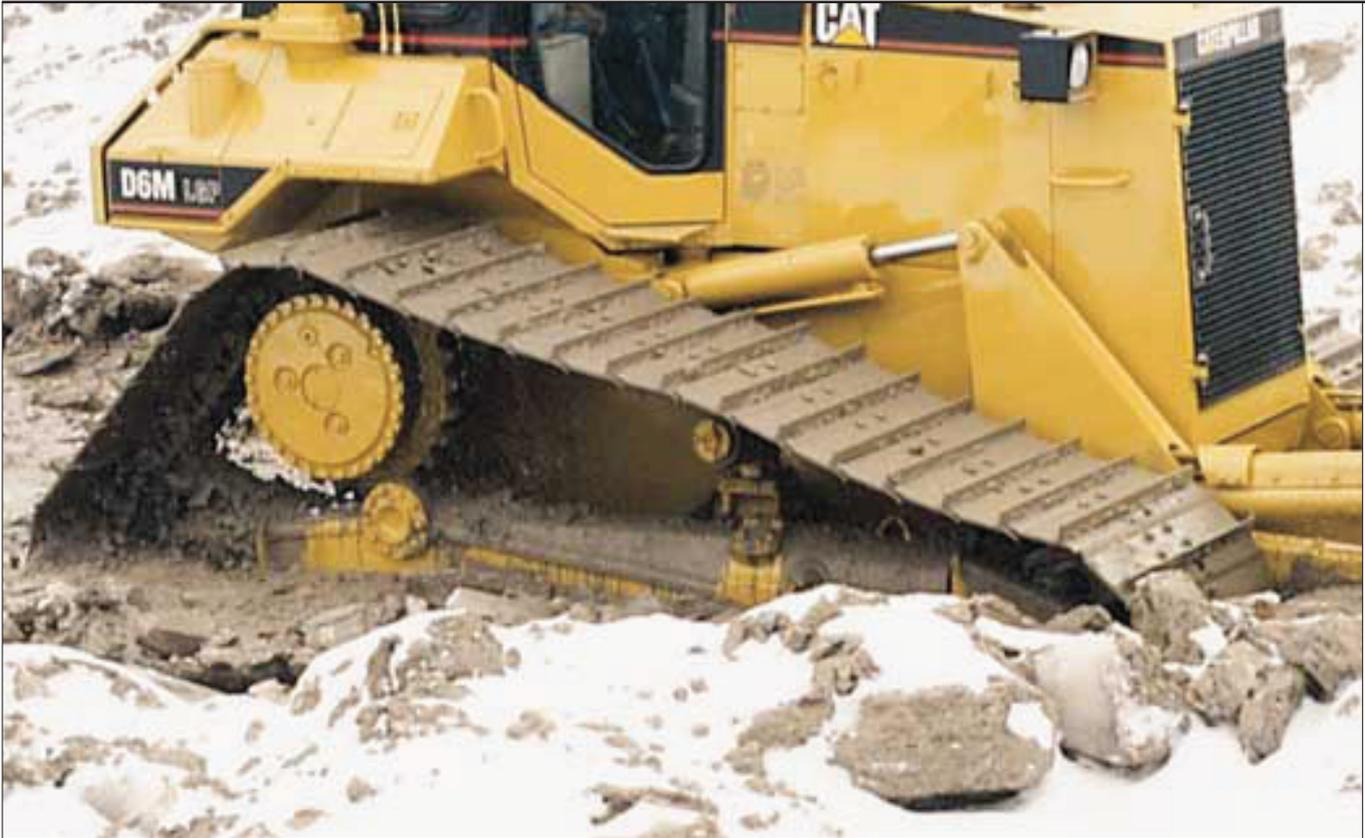
**Delta-Bauweise.** Da sich die Seitenantriebe mit den Zahnkranzsegmenten außerhalb des Arbeitsbereiches befinden, sind sie hervorragend gegen die Einwirkungen von Schmutz und Wasser geschützt. Überdies müssen sie keine Fahrstöße aufnehmen, weil diese Kräfte direkt in den Hauptrahmen geleitet werden.
