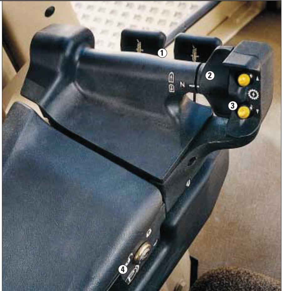
**Rückschaltautomatik.** Um bei häufigen Fahrtrichtungsänderungen die Schaltvorgänge zu minimieren, kann der Fahrer einen automatischen Rückschaltmodus wählen. Das Getriebe geht dann beim Richtungswechsel selbsttätig vom 1. oder 2. Vorwärtsgang direkt in den 2. Rückwärtsgang. Diese Schaltautomatik kann nach Belieben aktiviert oder deaktiviert werden.
