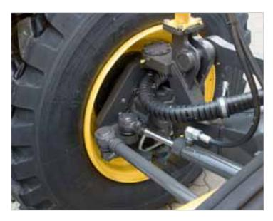
Die Radsturzverstellung garantiert eine extrem hohe Spurtreue und erlaubt ein sauberes und sicheres Arbeiten an Böschungen ohne Schubkraftverluste durch häufiges Gegenlenken. Beim Allrad-Modell werden die Vorderräder durch eine Verstellpumpe und Radnabenmotoren angetrieben.
