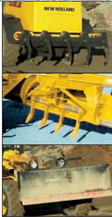
■ Heck- und Scharaufreißer sowie das Planierschild erweitern das Einsatzspektrum der NEW HOLLAND Grader
